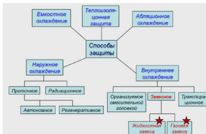
Рис. 1. Основные способы защиты стенок жидкостных ракетных двигателей [1]
