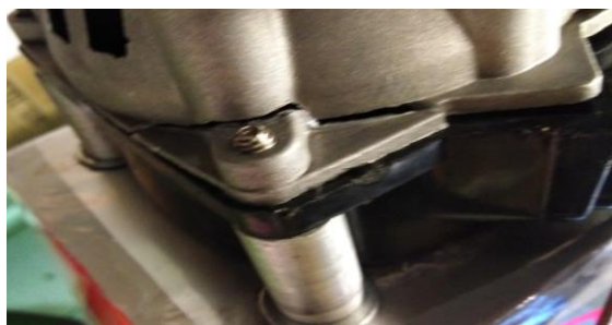
Рис. 20. Разрушение корпуса двигателя из-за отсутствия демпфирования опор крепления
