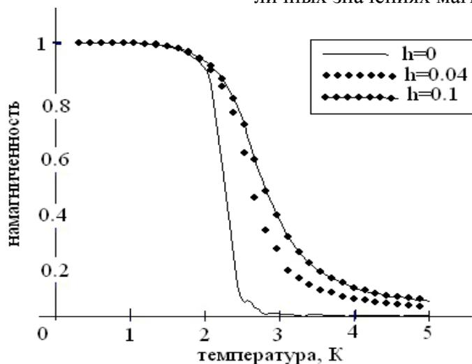
Рис. 1. Графики зависимости средней намагниченности от температуры для различных значений внешнего магнитного поля
