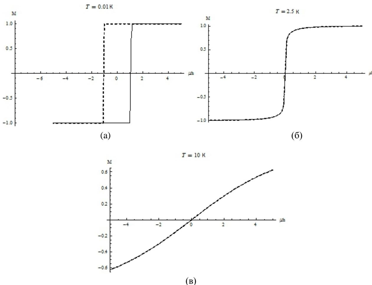
**Рис. 2. Гистерезис системы при различных температурах**
