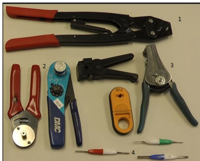
Рис. 4. Инструмент для работы с проводкой: 1 - обжимной инструмент для терминалов (клемм), 2 - обжимной инструмент для пинов; 3 - инструмент для зачистки изоляции проводов; 4 - "поплавки" под разные типы пинов
