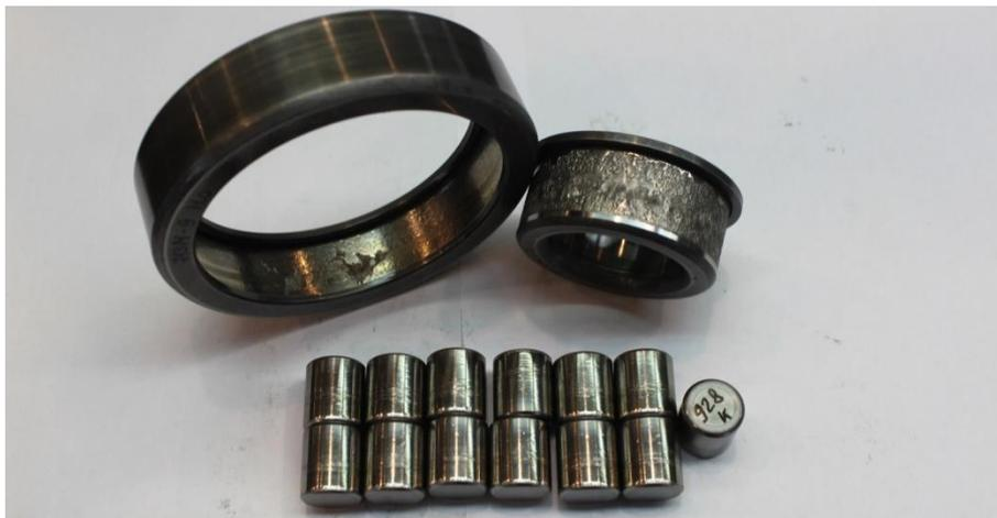
Рис. 1. Подшипник 6-42408К4 со следами разрушения
