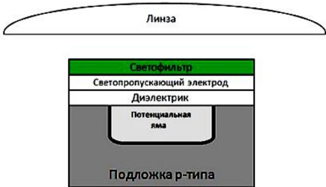
Рис. 1. Структура ПЗС пикселя
