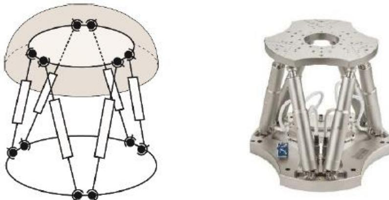
Рис. 1. Замкнутая структура манипулятора
