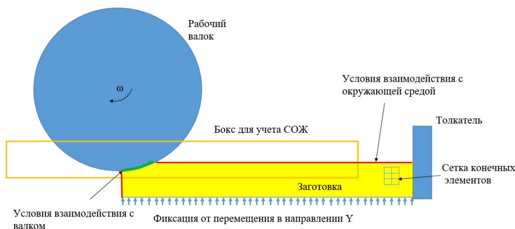
Рис. 1. Моделирование горячей прокатки в программе DEFORM-2D
