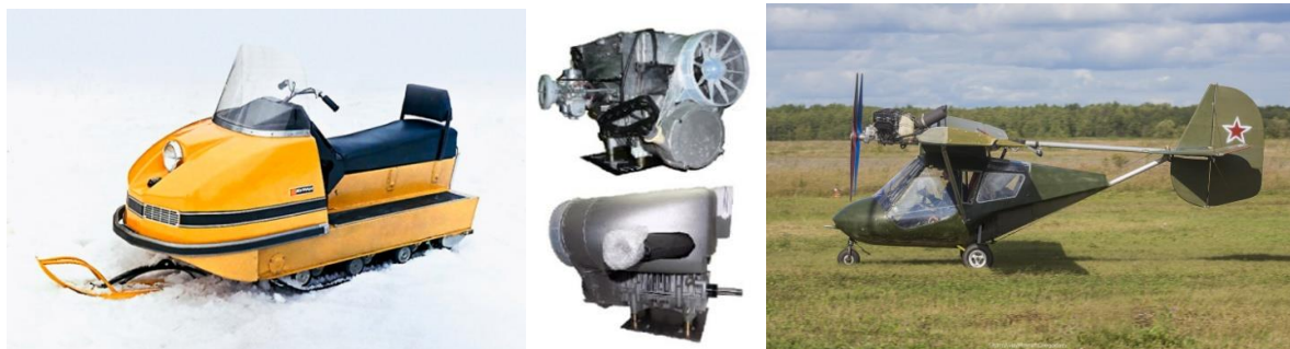
Рис. 2. Двигатель «PM3-640» на снегоходе «БУРАН» (слева), общий вид (в центре), применение двигателя на самолете АОН «Ветерок»
