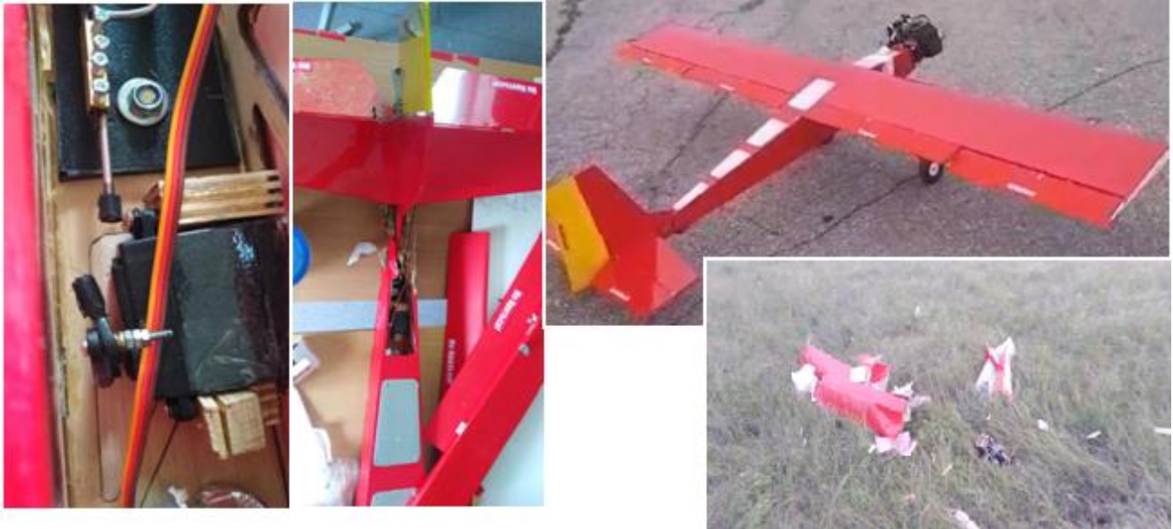
Рис. 21. Крушение ЛА из-за воздействия вибрации двигателя на систему управления
